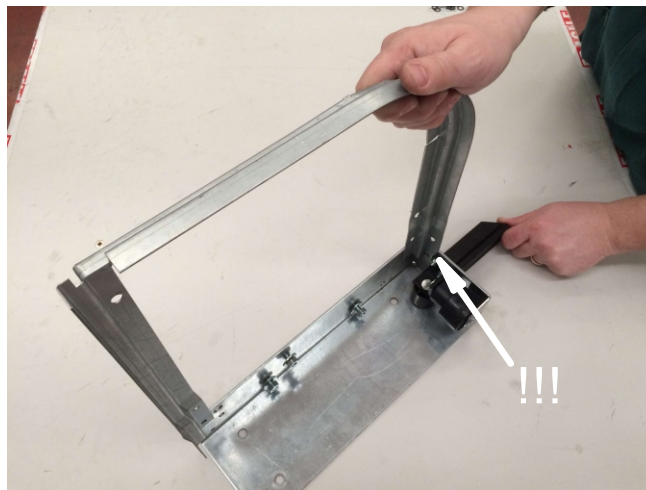
2: inserire la cornice del coperchio nel fianco
